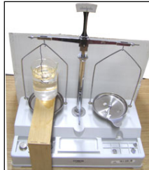
Figura 2.- Foto mostrando la pesada del alambre sumergido en agua
