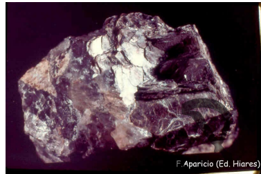
Figura 17.4.- Exfoliación basal de la mica
