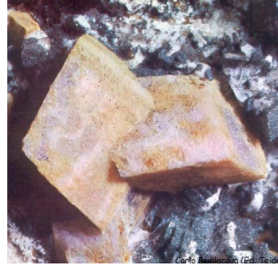
Figura 17.3.- Exfoliación romboédrica de la calcita
