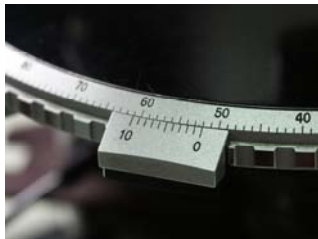
Platina graduada con vernier (se lee 52 °)
