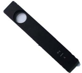
Lámina auxiliar de yeso indicando la dirección del índice de refracción n_\gamma
