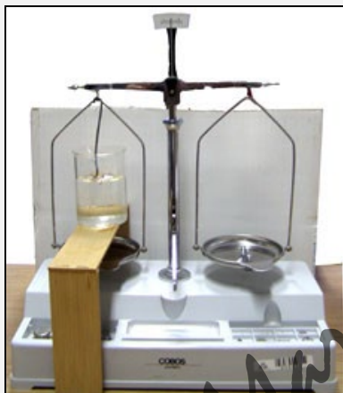
Figura 10.5.- Foto (izquierda) y esquema (derecha) representando el procedimiento de pesar el mineral en agua
