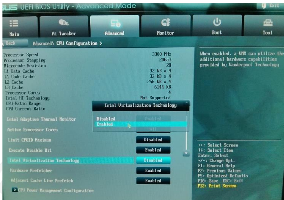
Ejemplo de soporte en BIOS de tecnología de virtualización por hardware
