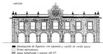
Fig. 5.- Tipos de limpieza llevados a cabo en la fachada de antiguo Hospicio Provincial de Oviedo.
