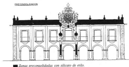
Fig. 4.- Zonas de la fachada preconsolidadas con Tegovakon V.
