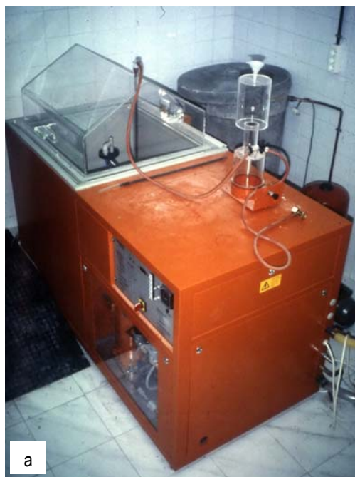
Figura 6.- Cámaras climáticas utilizadas en los ensayos de durabilidad. a) Cámara que permite realizar los ensayos normalizados de niebla salina y de niebla ácida. b) Cámara utilizada para los ensayos en atmósferas controladas, junto a la unidad que permite la dosificar el gas contaminante.
