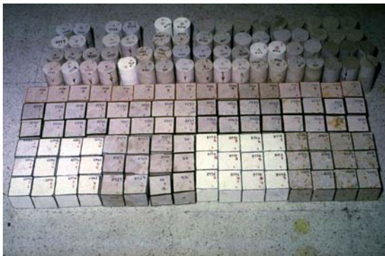
Figura 1.- Diferentes tipos de probetas, correspondientes a distintos materiales rocosos, preparadas para realizar varios ensayos de durabilidad.
