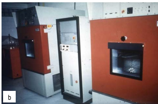
Figura 6.- Cámaras climáticas utilizadas en los ensayos de durabilidad. a) Cámara que permite realizar los ensayos normalizados de niebla salina y de niebla ácida. b) Cámara utilizada para los ensayos en atmósferas controladas, junto a la unidad que permite la dosificar el gas contaminante.
