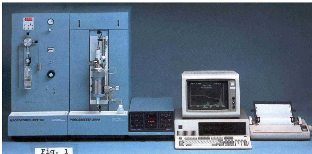
Figura 1. Equipo porosimétrico formado por la unidad "Macropore 120" (izquierda) para la determinación de la macroporosidad, la unidad "Porosimeter 2000 WS" y su módulo de registro (centro) para la microporosidad y un ordenador para el tratamiento y presentación de los datos suministrados por ambas unidades
