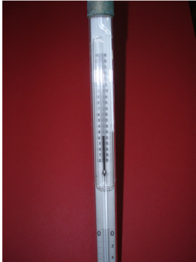
Figura 4. Detalle de la escala auxiliar de un termómetro Beckmann.
