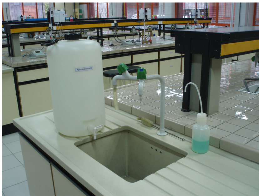
Figura 2. Módulo de lavado. La escobilla y el detergente deben utilizarse si el agua no es capaz de eliminar por completo la suciedad del material de vidrio.
