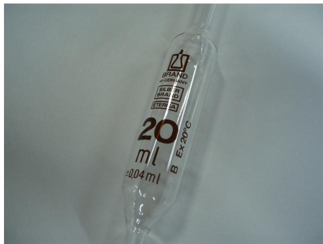
Figura 5. Detalle de las especificaciones técnicas de una pipeta graduada (vertido total, tipo 3) y una pipeta con una línea de enrase (pipeta de un aforo).
