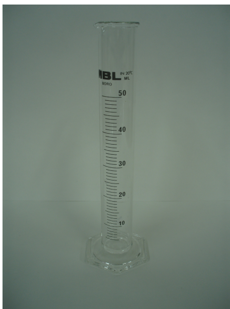
Figura 7. Probeta cilíndrica graduada.
