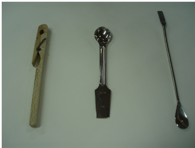
Figura 21. Pinza para tubos de ensayo y dos espátulas dobles (plana y cuchara) de diferentes tamaños.
