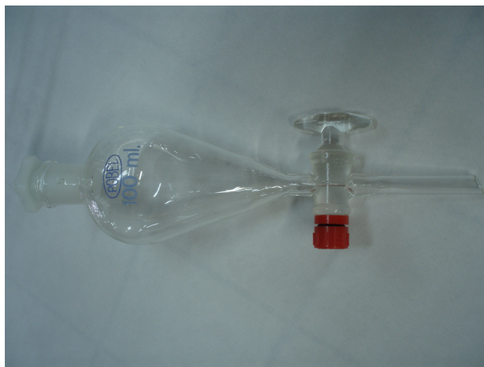
Figura 13. Embudo piriforme de llave para decantación.
