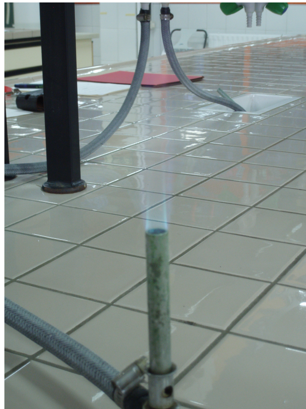
Figura 18. Izquierda: Llama con aire cerrado (combustión incompleta). Derecha: Llama con aire abierto (combustión completa).
