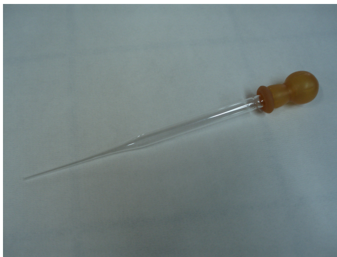
Figura 2. Cuentagotas. Se utiliza con mucha frecuencia en el laboratorio para medir, de forma aproximada , cantidades muy pequeñas de líquidos. El volumen de una gota no es igual para todos los cuentagotas, ya que depende del tamaño del orificio y de la naturaleza del líquido vertido. De hecho, cuando se vierte agua, se utiliza la aproximación 20 gotas \approx 1 mL.
