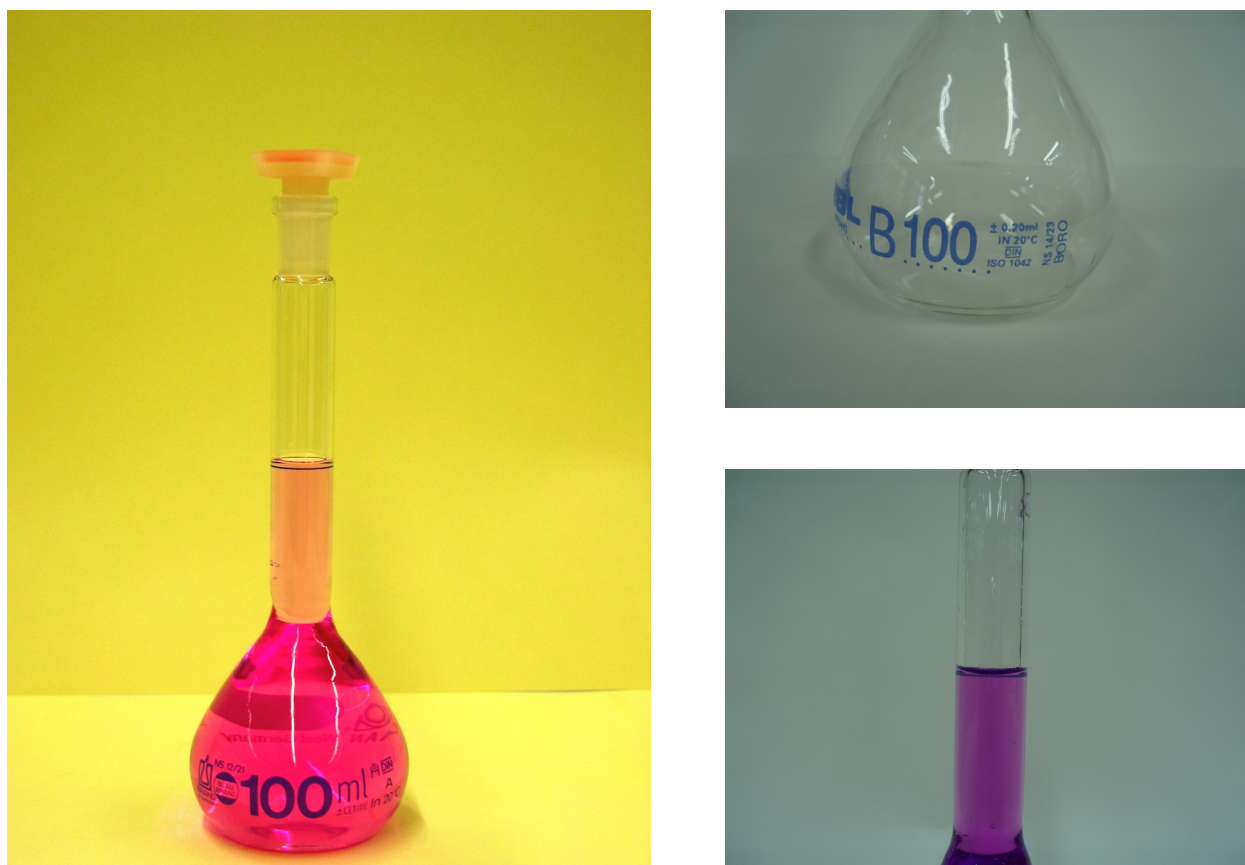
Figura 1. Izquierda: Matraz aforado. Derecha: En la parte superior se muestran en detalle las especificaciones técnicas de otro matraz. Puede observarse el volumen nominal o aforo (100 mL), la categoría (clase B), la temperatura de referencia (20 °C) y la etiqueta que lo califica como material de contenido ("In"). También aparece el error asociado a la medida ( \pm 0,20 mL), una etiqueta ("BORO") que hace referencia al material con el que se fabricó el matraz (vidrio borosilicato) y una etiqueta "NS 14/23" que indica las dimensiones del tapón troncocónico (14 mm de diámetro máximo y 23 mm de altura). La norma ISO 1042 se refiere a las características técnicas que deben cumplir los matraces aforados con una línea de enrase. En la parte inferior se puede observar el menisco (cóncavo) ajustado a la línea de enrase del matraz.
