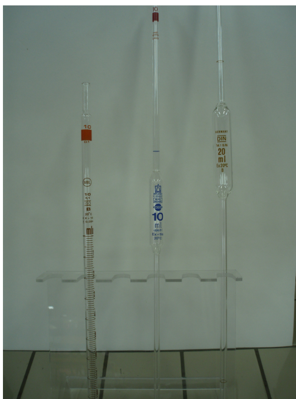
Figura 4. Diferentes pipetas (una graduada, a la izquierda, y dos de un aforo, en el centro y a la derecha) sobre un soporte de plástico.
