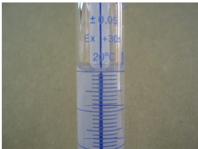
Figura 3. Izquierda: Enrase de una bureta con franja Schellbach en la línea cero de la graduación. También se puede observar el error asociado a la medida ( \pm 0,05 mL), la etiqueta que la califica como material de vertido ("Ex"), la temperatura de referencia (20 °C) y el tiempo de vertido (30 s). Derecha: Llave de paso de PTFE (politetrafluoroetileno).
