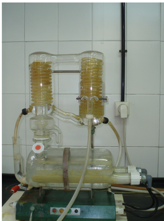
Figura 15. Equipo de producción de agua destilada. Pueden observarse dos refrigerantes en la parte superior.
