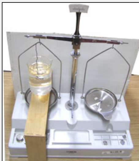
Figura 10.4.- Foto mostrando la pesada del alambre sumergido en agua
