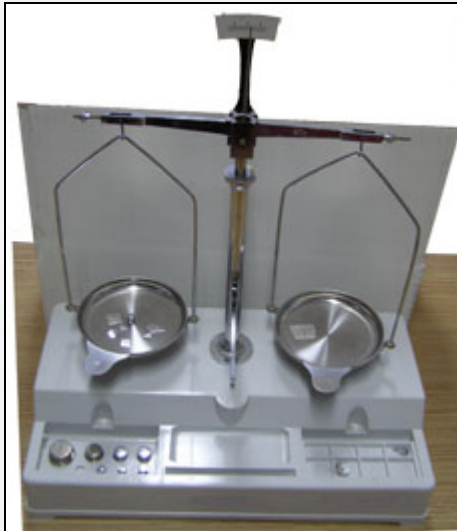
Figura 10.3.- Foto (izquierda) y esquema (derecha) representando el procedimiento de pesar el mineral en aire
